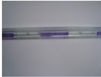
Rys. 1. Laminarny przepływ korkowy glikol etylenowy-powietrze
