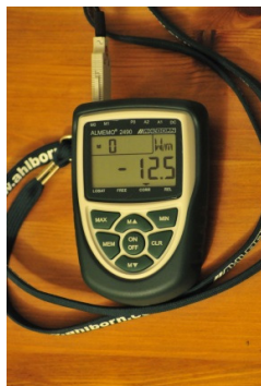
Fot. 4, 5. Urządzenie pomiarowe oraz sonda na przegrodzie wewnętrznej do pomiaru strumienia ciepła
